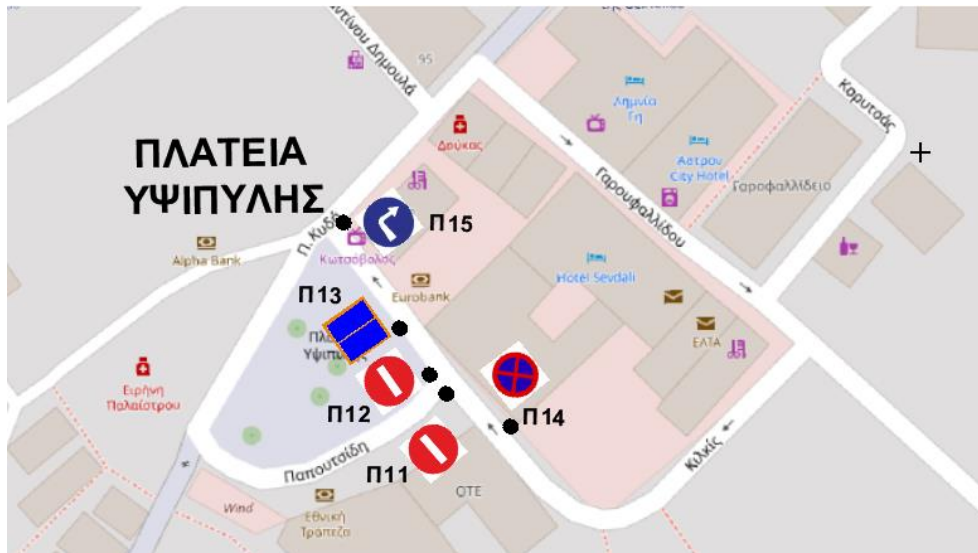
Εικόνα 5: Απόσπασμα του χάρτη στο οποίο αποτυπώνονται οι προτεινόμενες κυκλοφοριακές ρυθμίσεις στην πλατεία Υψιπύλης.
